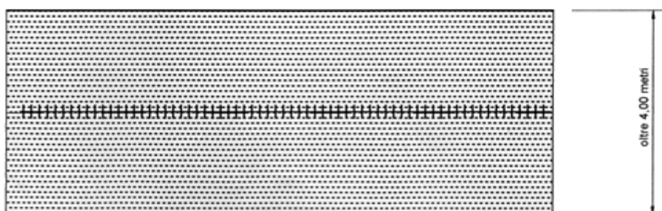
figura 14 scavo al centro della strada
